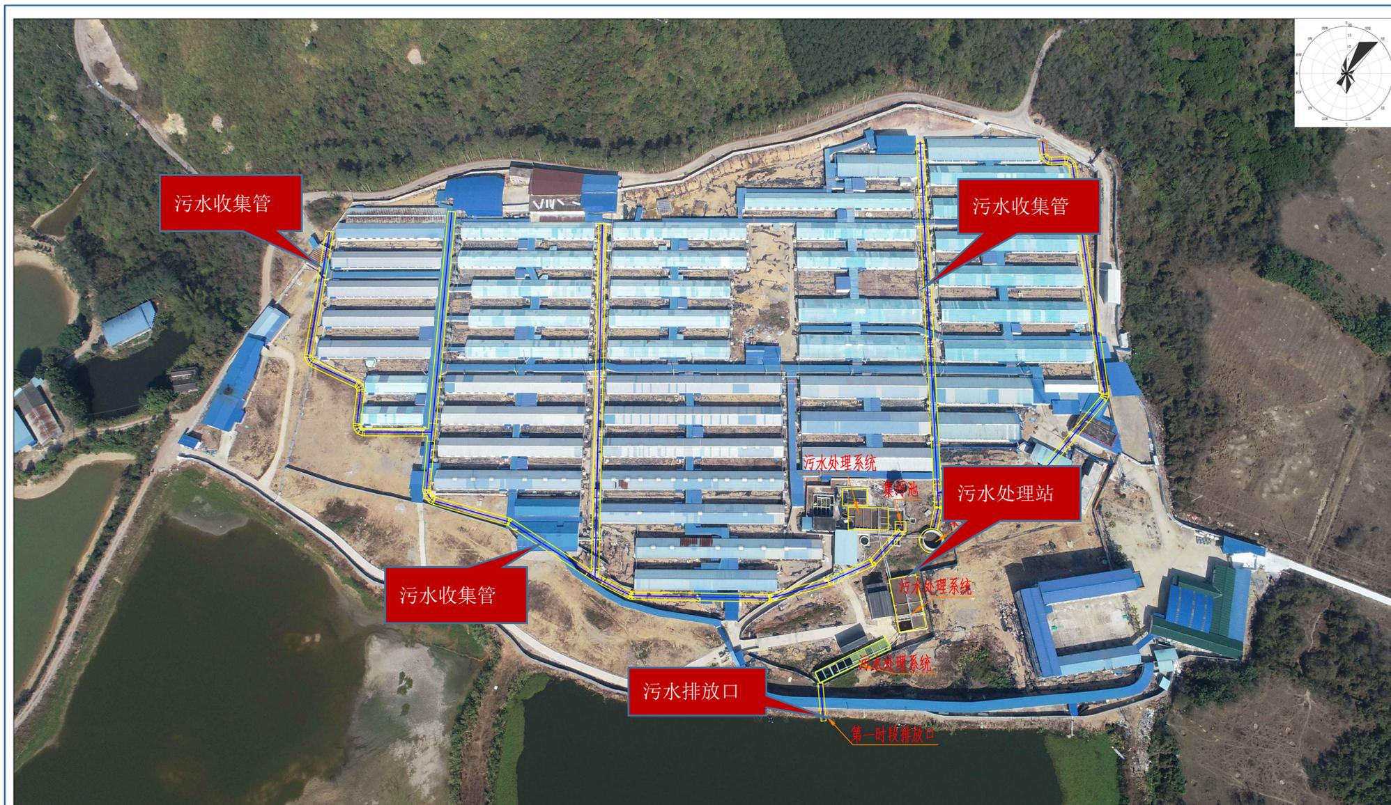
图 2.1-3 项目污水收集管网图
