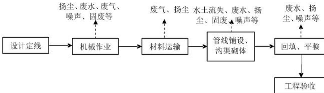
图 5-1 施工期工艺流程图
