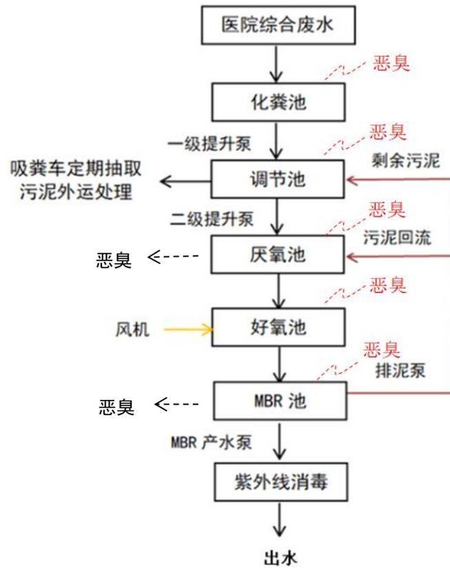
图 5-3 污水处理站工艺流程图
