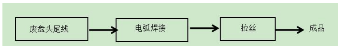
图 4-4-2 盘条头尾线拉丝车间工艺流程及产污节点图
